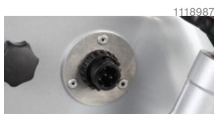
Schnittstelle FireCAN zur genormten Kommunikation
