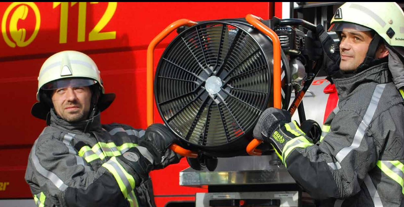
Hochleistungslüfter ermöglichen durch effektive Belüftung brennende Gebäude und Einsatzstellen von Rauch, Hitze und giftigen Gasen zu befreien. Die Bedingungen im Einsatz werden entscheidend verbessert. Der Angriffstrupp kann sich schneller im Objekt orientieren und eine effektivere Brandbekämpfung durchführen.
